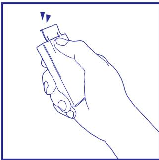
上図のように、ケース上部の筒所を押し込みます。
